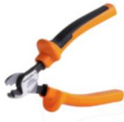
Schneidwerkzeuge für Leiter bis 8 mm, 12 mm, 14 mm bzw. 22 mm Außendurchmesser. Die spezielle Schneidengeometrie ermöglicht ein quetschfreies Schneiden von Kupfer- und Aluminiumleitern mit minimalen Handkräften. Zudem besitzen die Schneidwerkzeuge (KT 8 bis KT 22) VDE- und GS-geprüfte Schutzisolationen bis 1.000 V gemäß EN/IEC 60900.
