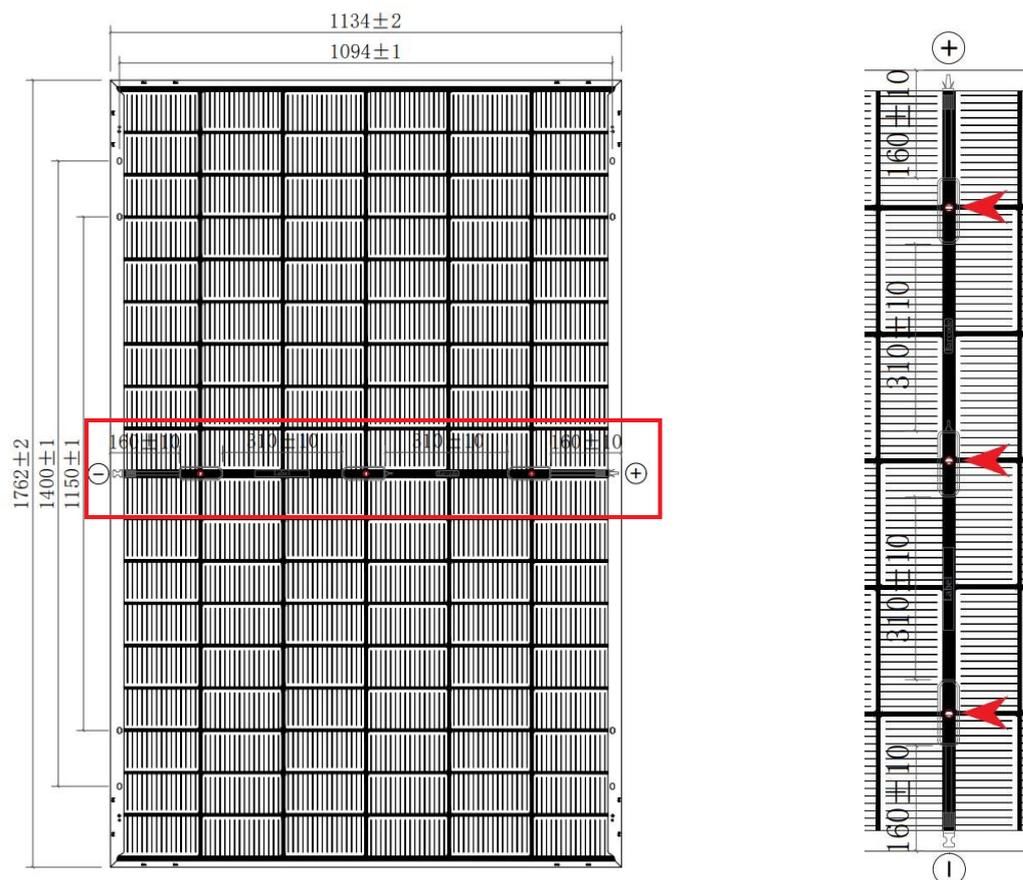
Abbildung 4: Anordnung Anschlussdosen
