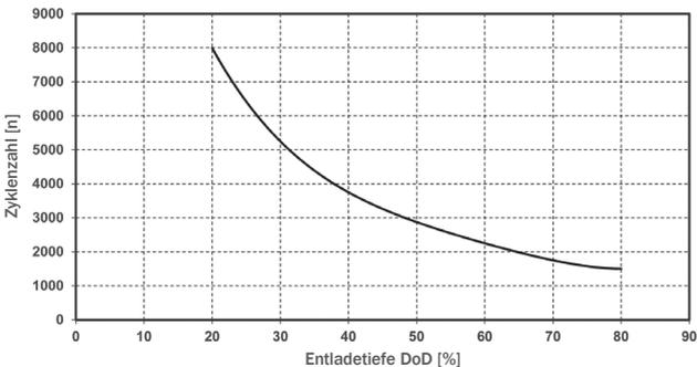
Abb. 7-8: Haltbarkeit in Zyklen einer sun | power v<sub>L</sub> (OPzS solar.power) als Funktion der Entladetiefe (bei 20 °C)
