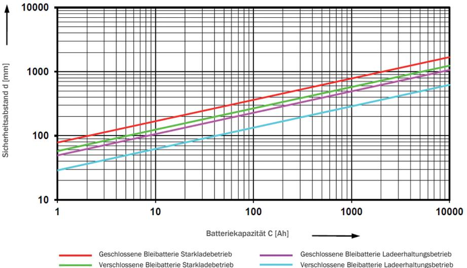
Abb. 5-1: Sicherheitsabstand in Abhängigkeit von der Batteriekapazität
